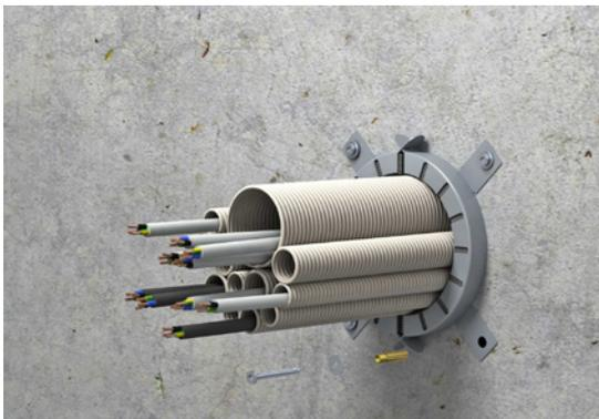
4. Die Enden der Elektroinstallationsrohre sind aus Rauchschutzgründen mit GFM mindestens 20 mm tief zu verfüllen.
