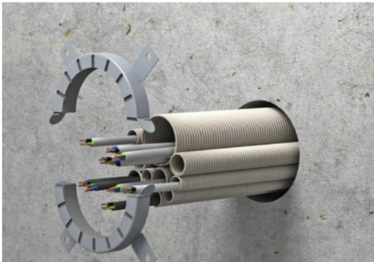
2. Alle Restöffnungen um das Bündel mit Verschlussbaustoff verfüllen. Die Zwickel zwischen den einzelnen Leerrohren müssen nicht verfüllt werden.
